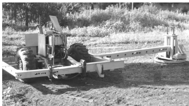
Рис. 1 – Стенд для исследования работы одноосного колёсного движителя при криволинейном движении
